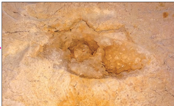
Рис.6. Пустотка в облицовочной плитке иерусалимского камня. Справа — схема ее внутреннего строения: 1 — стенка раковины, 2 — щеточка кристаллов кальцита, инкрустирующая внутреннюю поверхность стенки раковины, 3 — микросталактит, 4 — микросталагмит.
