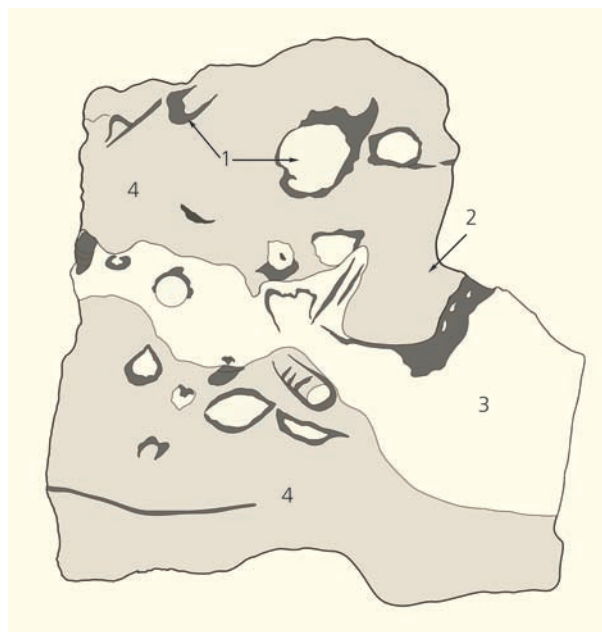
Рис.5. Схематическая зарисовка поверхности образца: 1 — ориентированные наклонно раковины, 2 — отдельный столб стилолита, 3 — исходный первичный известняк, 4 — зоны уплотнения, прилегающие к стилолитовой поверхности.
