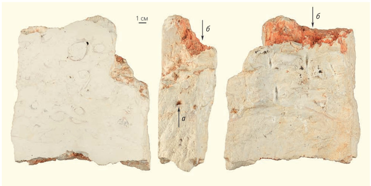
Рис.4. Фотография образца с трех сторон. Стрелками показаны: раковина — «геологический уровень» (а) и поверхность зеркала скольжения (б).
